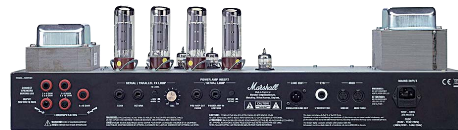
写真5 チューブ・アンプは信号の増幅に真空管が使われています。温かみのある歪みは真空管ならではの
